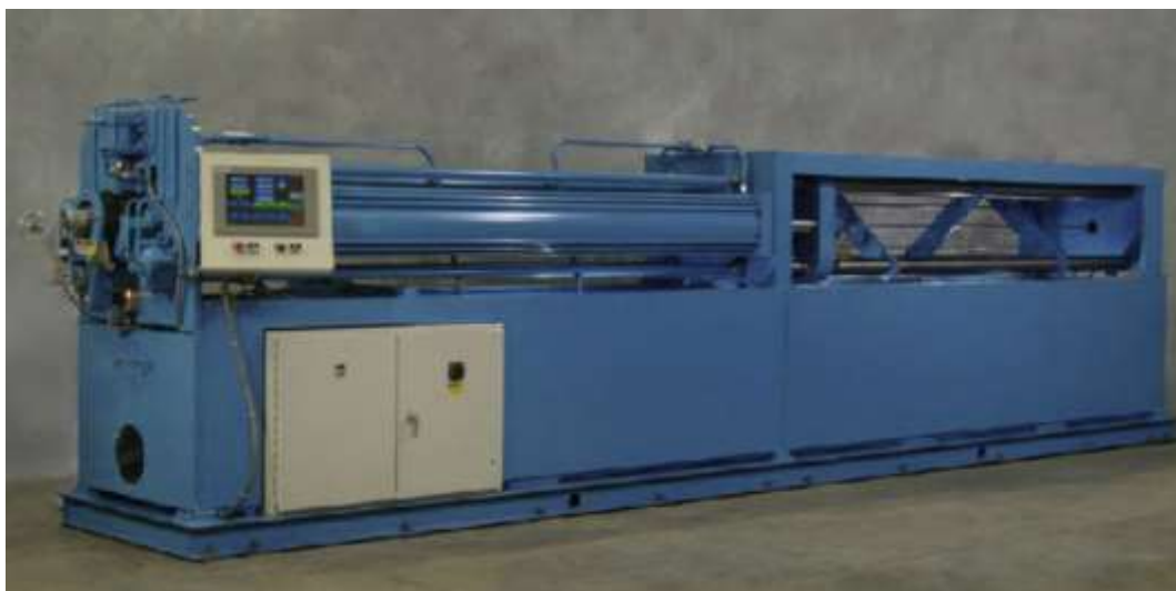
شکل 9. اکسترودر افقی مورد استفاده در روش paste extrusion به منظور روکش نمودن سیم فلزی [1]
